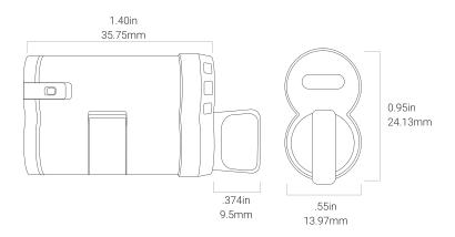
**Batterie:** 1025 **Schutzklasse:** IP67 **Temperaturbereich:** -70°F to 185°F/-55°C to 85°C
