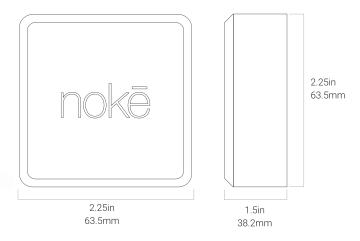
**Batterie:** AA Optional **Schutzklasse:** IP67 **Temperaturbereich:** -70°F to 185°F/-55°C to 85°C
