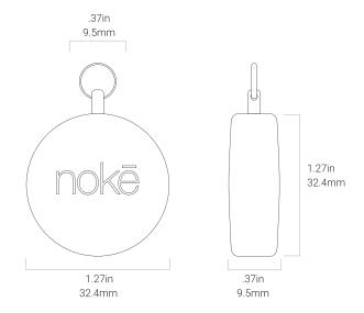
**Batterie:** 2023 Knopfzelle **Schutzklasse:** IP66 **Temperaturbereich:** -10°F to 150°F/-23°C to 65°C
